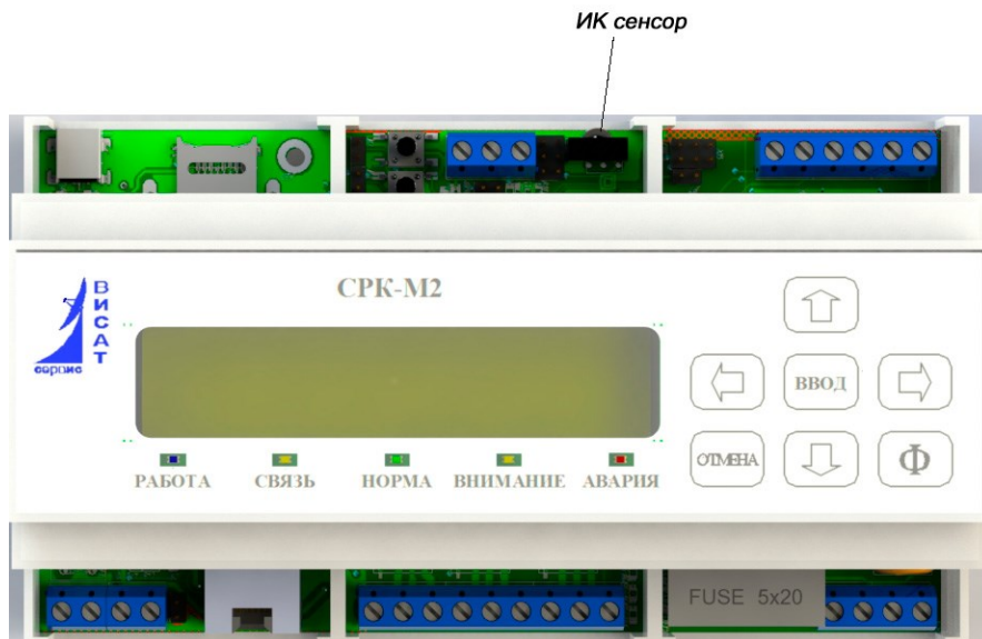
Рисунок 5.4 – Расположение ИК сенсора
