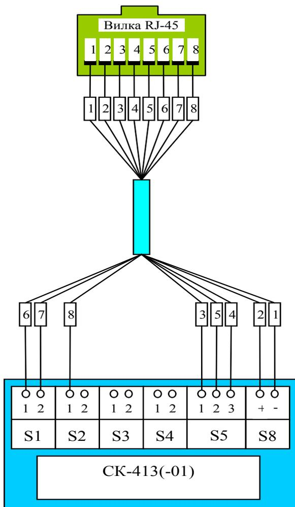
Схема подключения к
