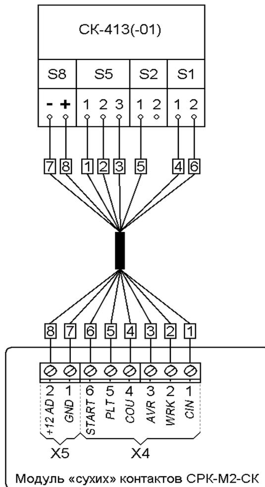
Схема подключения к
