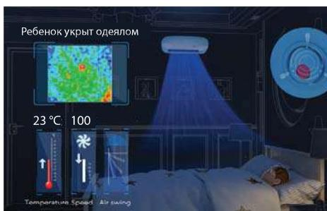
Датчик оценивает соотношение площадей с разной температурой. Открыто только лицо. Кондиционер работает в предустановленном режиме.
